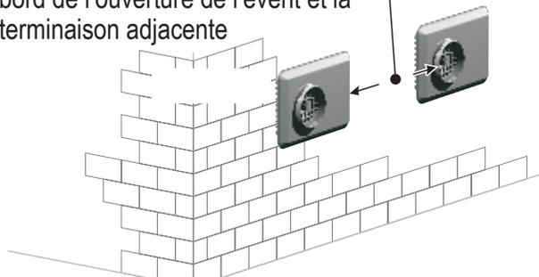
**Figure 40** Préparation du trou dans le mur – VUE INTÉRIEURE (utiliser le gabarit fourni)
