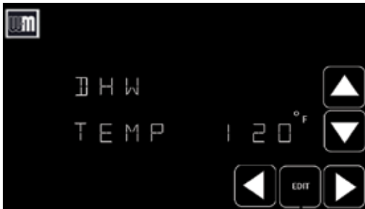
Figure 7 Commandes de l'afficheur du module de commandes ECO Tec pour le propriétaire d'une chaudière combinée
